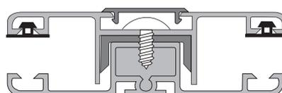
**Rondelloni per il fissaggio del polycarbonato.**
